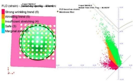
Figure 10. FLD Strain D8O10L0.5.
