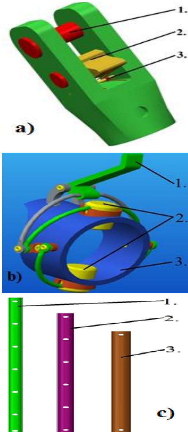
Figure 4. Elementele componente ale subansamblului de susținere: a) cylindrical hinge; b) locking sections system; c) sections;
